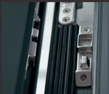
Антизломні штирі - це додаткове устаткування, яке покращує антизломні характеристики дверей. Вони встановлюються з боку петель на дверному полотні та на коробці. Залежно від необхідного ступеню безпеки можна застосовувати різну кількість наборів для одного полотна.
