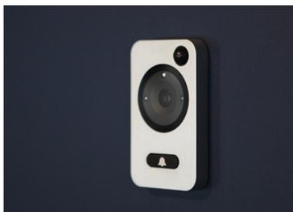
Электронный дверной глазок со звонком, памятью и камерой с датчиком движения, которая фотографирует в инфракрасном диапазоне
